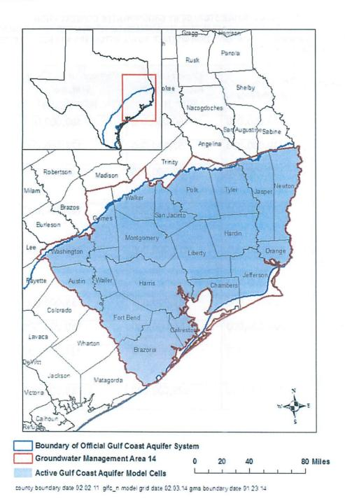
FIGURE 6. EXTENT OF THE GROUNDWATER AVAILABILITY MODEL FOR THE NORTHERN PART OF THE GULF COAST AQUIFER SYSTEM USED TO ESTIMATE TOTAL RECOVERABLE STORAGE (TABLES 9 AND 10) FOR THE GULF COAST AQUIFER SYSTEM WITHIN GROUNDWATER MANAGEMENT AREA 14.
